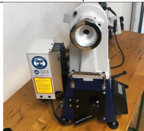
Inwerter w metalowej obudowie
